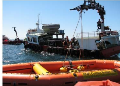
Foto: Servizo de Gardacostas de Galicia. Labores de recollida con barreira especializada (Current Buster) apoiada por profesionais do mar
